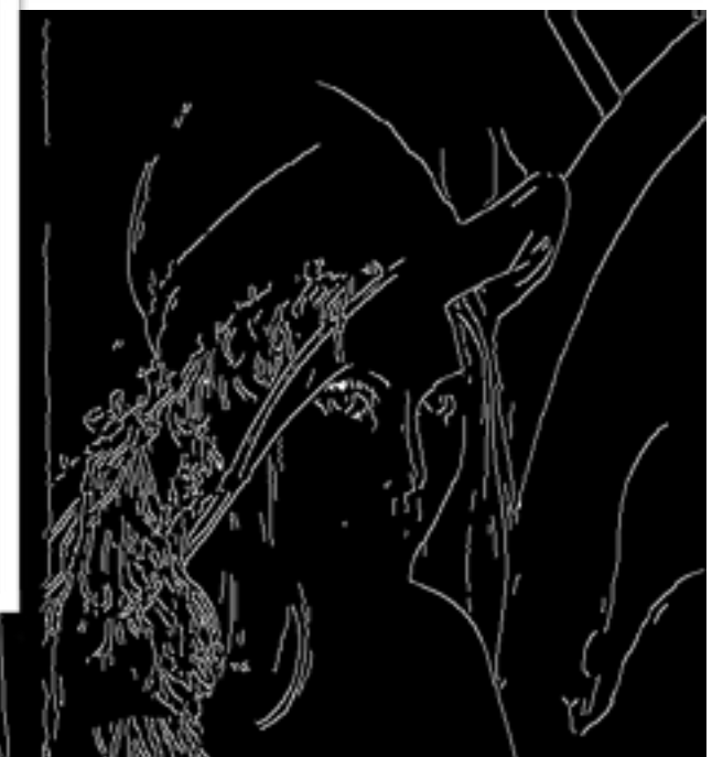
Canny edge detection
